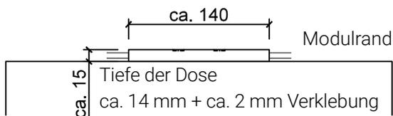
Randanschlussdosen werden nur nach Absprache und technischer Prüfung eingesetzt. Anstelle von Randanschlussdosen empfehlen wir die Split-Box 1 einzusetzen. In den meisten Fällen ist die Anwendung von der Split-Box 1 möglich.
